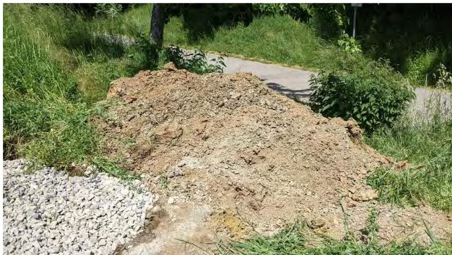
Bild 11: Baggeraushub aus Schurf S1 – V1.
