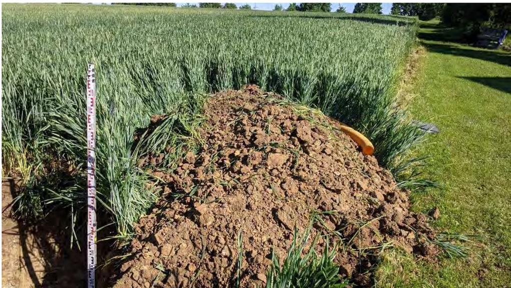
Bild 11: Baggeraushub aus Schurf S2 – V2.
